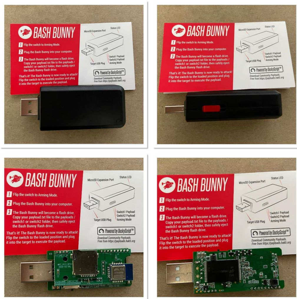
Beispielhafte Abbildung eines Multi-Vektor-USB-Geräts (Bash Bunny Mark II)
